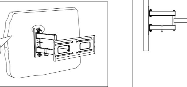
**2** Instale o suporte na parede utilizando quatro parafusos e quatro anilhas metálicas.
