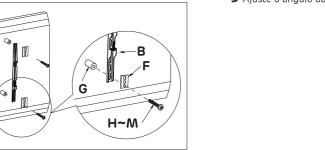
**3** Instale os fixadores na parte traseira da TV. Use dois parafusos e duas anilhas metálicas quadradas em cada fixador. Os parafusos deverão ser selecionados de acordo com as dimensões dos furos. Use os espaçadores, caso necessário.
