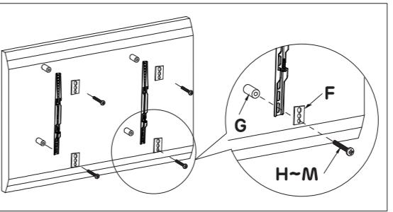
**3** Instale los soportes en la parte trasera del televisor. Utilice dos pernos y dos arandellas cuadradas de metal en cada soporte. Los pernos deben seleccionarse de acuerdo con las dimensiones de los agujeros. Utilice los espaciadores si es necesario.
