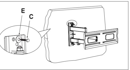
**2** Instale el soporte en la pared con cuatro pernos y cuatro arandellas de metal.
