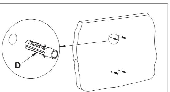
**1** Use la placa de pared del soporte como plantilla para marcar cuatro agujeros. Si es una pared de hormigón, los agujeros deben tener 10 mm de diámetro y 50 mm de profundidad. Colce los cuatro anclajes de plástico en los orificios perforados. Si se trata de una pared de madera, no necesitarás utilizar los tacos de plástico. Haga cuatro orificios piloto pequeños y simplemente atornille los pernos autorroscantes directamente en la pared.
