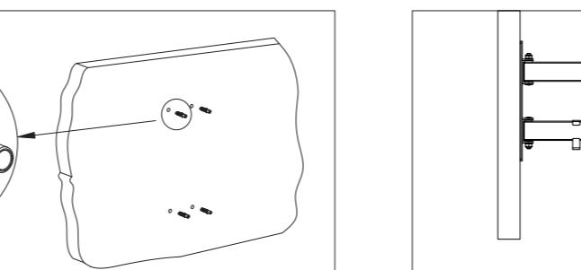
**1** Use a placa de parede do suporte como modelo para marcar quatro furos. Caso seja uma parede de betão, os furos deverão ter 10 mm de diâmetro e 50 mm de profundidade. Encaixe as quatro buchas de plástico nos orifícios perfurados. Caso seja uma parede de madeira, não precisará de usar as buchas. Faça quatro pequenos orifícios piloto e simplesmente fixe os parafusos autorroscantes diretamente na madeira.
